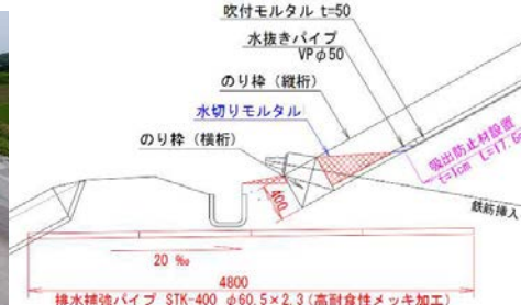
図3 小段付近の湧水対策
