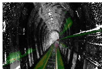
図-2 高密度断面計測機計測状況 と出力されるデータ例
