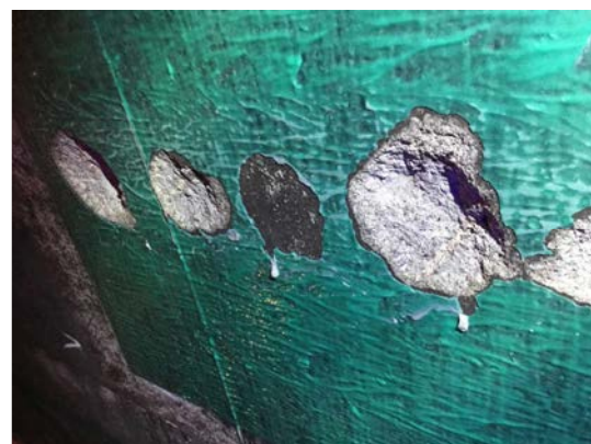
写真-4 破壊状態のばらつき（改質剤なし）
