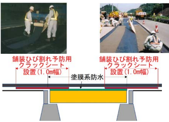
図-3 クラックシートを応用した止水工法イメージ図
