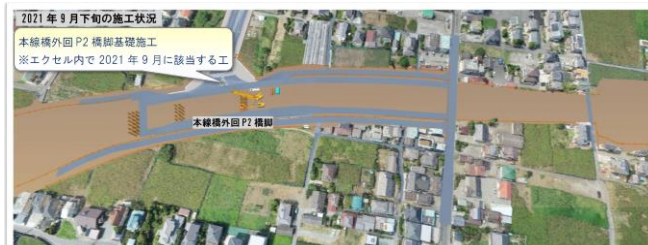
図 6 4D (工期) の CIM モデル作成事例
