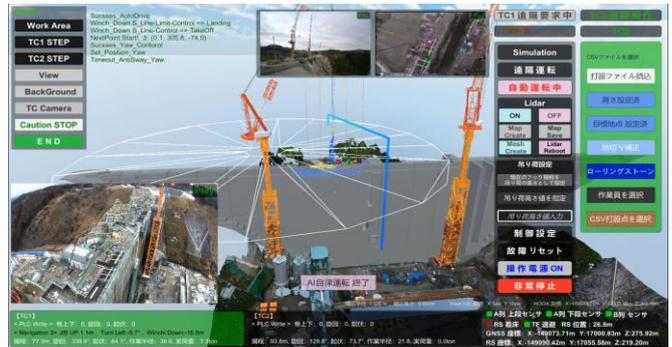
図-4 CPSによるタワークレーン自動運転の施工モデル
