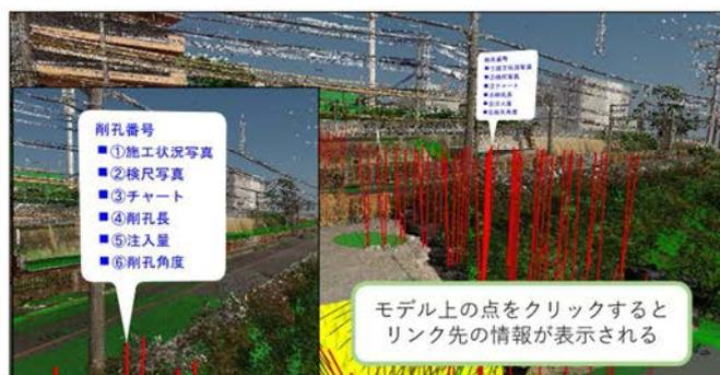
図-7 3Dモデル(施工データの付加)
