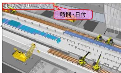
図-7 4D 施工シミュレーション
