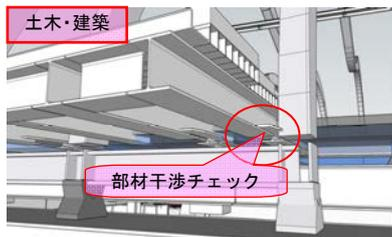
図-4 設計図の 3D 統合モデル
