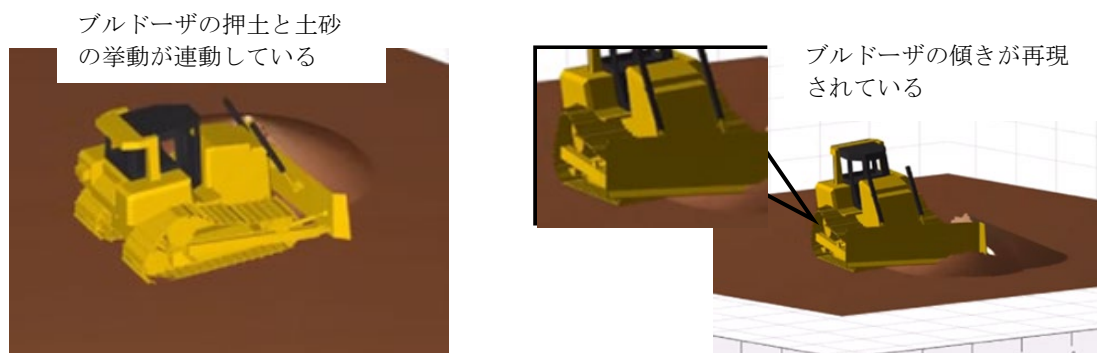
図4 シミュレーション結果（左：ブルドーザ後方側面図, 右：ブルドーザ前方図）
