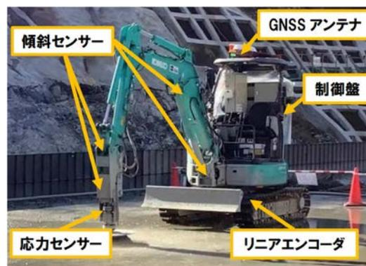
写真-2 グリーンカットマシン機器配置図
