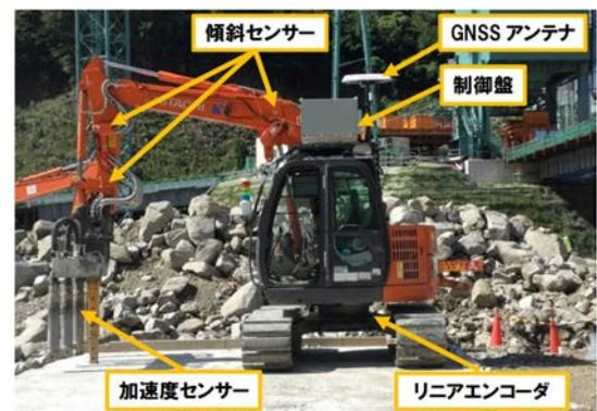
写真-1 バイバック機器配置図
