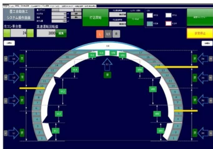
図-1 覆工自動施工システム制御画面
