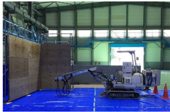
写真-1 吹付機試作機
