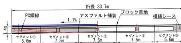
図-2 海上連絡橋1径間の側面図
