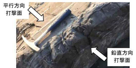
図-3 泥岩の堆積構造と打撃方向
