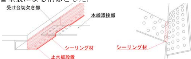
図-5：水平継手部止水工(内面)
