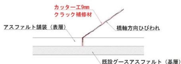
図-6：舗装部対策工
