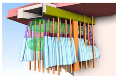
図1 非開削工事全体イメージ図と3次元BIMモデルによる凍土管理状況図
