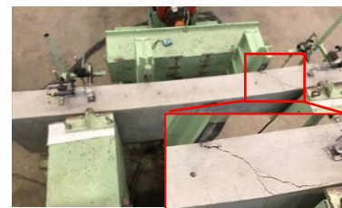
写真-3 セン断試験 破壊時の状況
