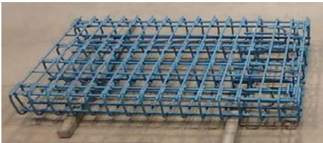
写真－1 曲げ試験用の筋材組立状況
