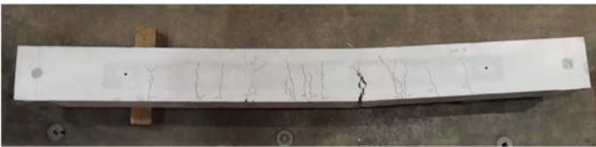
図9 試験体のひび割れ発生状況（側面）
