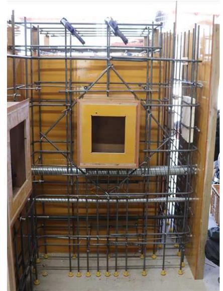
写真-4 ③配筋探査 試験壁 (開口部, シース管, PC 鋼棒)
