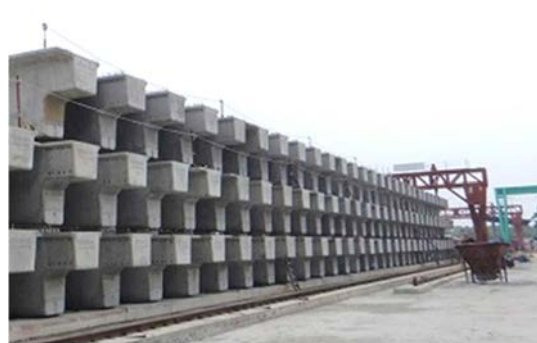
写真 1 桁ストック状況(3 段)
