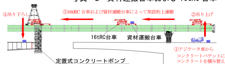
図-2 間詰部コンクリート供給方法
