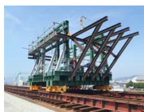
写真-5 セグメント運搬台車
