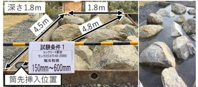
図-3 試験体(左:試験前 右:水張り試験時)
