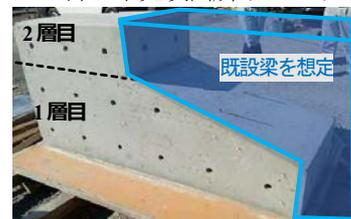
写真-2 梁の模擬供試体
