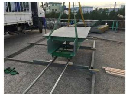
写真-3 丸鋼管レール軌条を用いた運搬試験
