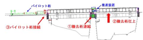
Step2: 桁引戻し・切断解体搬出
