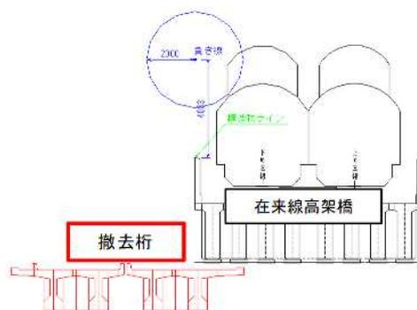
図-1 PC 桁および北陸本線高架橋断面図
