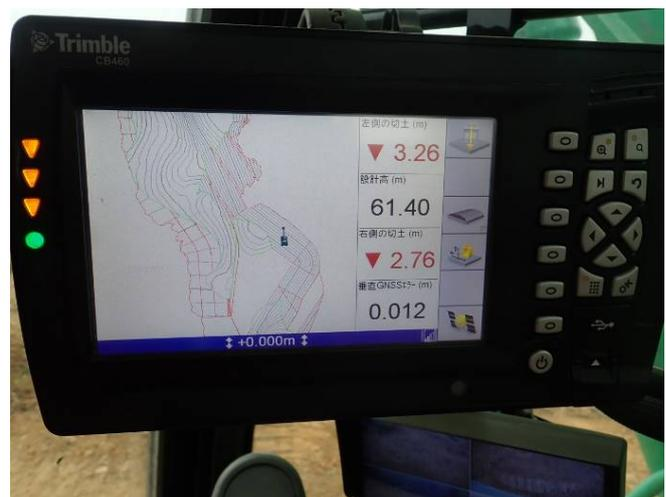
写真-3 施工データの実装状況
