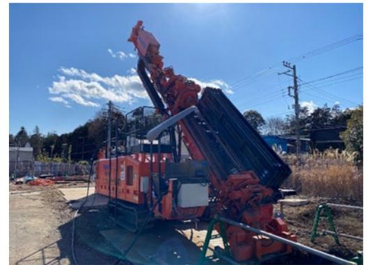
写真-1 NaviX 施工機
