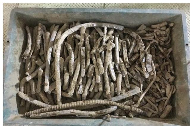
写真-3 既設杭切削後の回収鉄筋片
