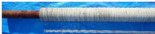
図5 シース管充填状況の一例
