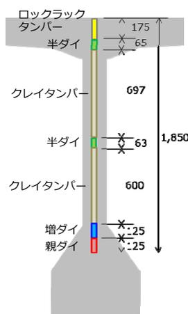
図-3 桁の装薬例
