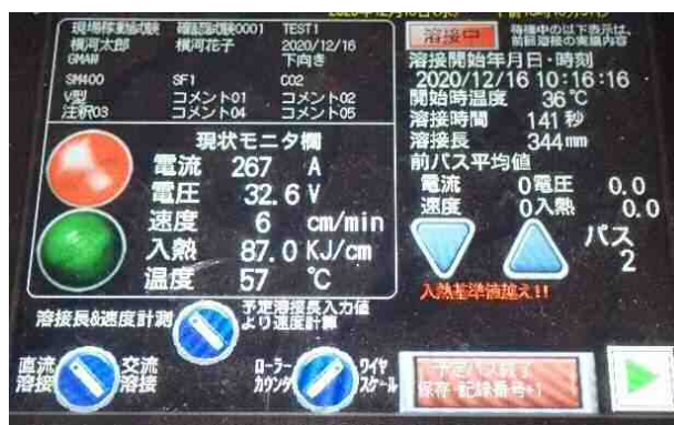
写真-3 溶接中のモニタ画面
