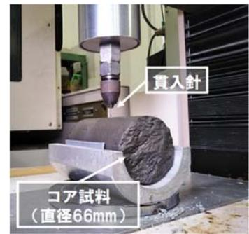
図1 机上型装置と本取り組みでの測定状況
