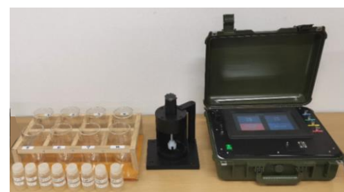
写真-1 固化材含有量計測システム
