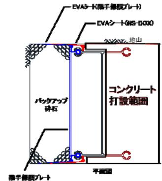
図-1 先行EL端部鋼材平面図
