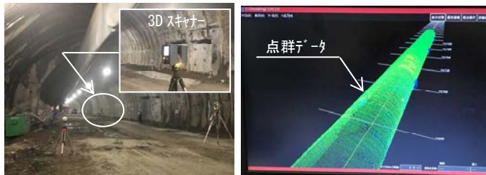
写真-1 3Dレーザースキャナー計測状況と点群データ
