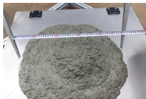
写真-3 受入れ試験時コンクリート性状
