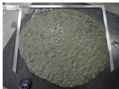
写真-1 加振後のスランプ フロー状況
