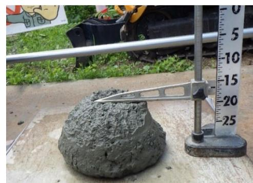
写真-2 受入れ試験時コンクリート性状
