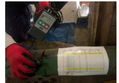
写真-2 圧送管点検状況
