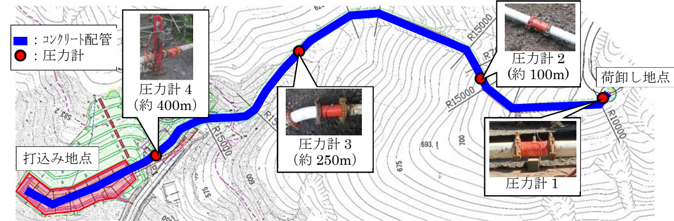
図-1 配管状況、圧力測定実施箇所
