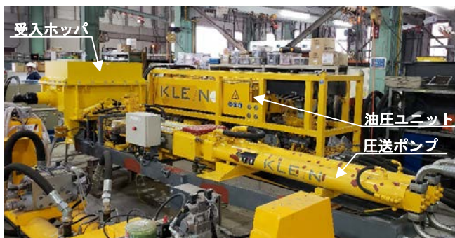
写真-1 コンクリート圧送ポンプ
