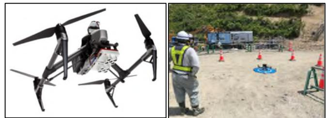
図-1 マルチスペクトルカメラの外観（左：MicaSense社HP<sup>2)</sup>より引用）と現場における使用状況（右）
