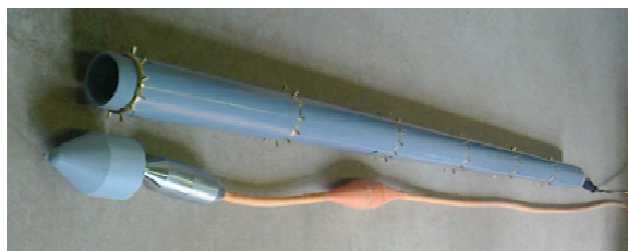
写真-2 DRi ログ内部 (弾性波受振器)
