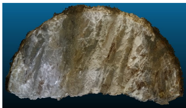
図-2 切羽の3D点群データ例
