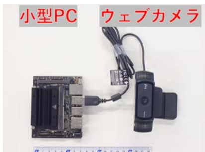
図-1 システム外観 (ウェブカメラと小型PC)
