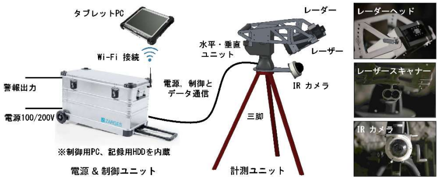
図-1 切羽肌落ち監視レーダーの構成
