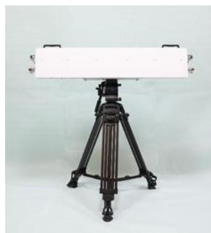
写真-1 レーダアンテナ外観
