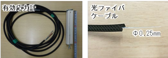
写真-2 有効応力計および光ファイバケーブル
