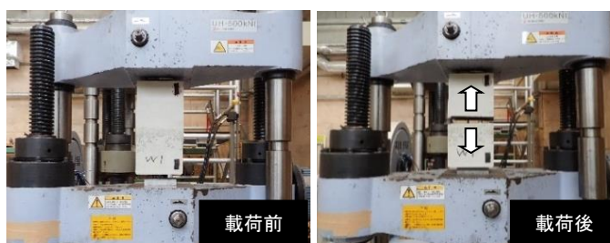
写真-2 直接引張試験の状況
