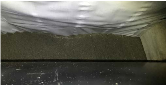
写真-3 高流動コンクリートの流動状況
