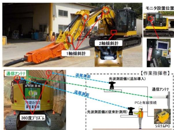
図-1 T-アタリパーフェクター システム構成
